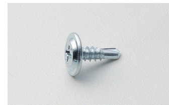
VITE AUTOFILETTANTE ZINCATA BIANCA TESTA LARGA PIATTA PUNTA TRAPANO
