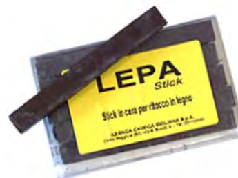
Bastoncini in cera naturale, di facile utilizzo, per eliminare presto e bene tutti i difetti del legno laccato e corrosivo. Dopo aver reso malleabile con il calore della mano lo stick, basta anche un coltello per stuccare la parte danneggiata. È possibile fondere (80°C) stick di colore diverso per ottenere tonalità particolari. Le superfici trattate possono essere riverniciate con qualsiasi prodotto di rifinitura. Cofezione: 10 Pz
