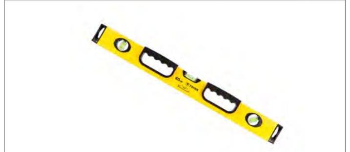
Livello in alluminio TOPEX. Dispone di 3 file che consentono di misurare piani verticali, orizzontali e inclinati di 45°. L'accuratezza della misurazione è 0,029° = 0,5 mm / m. Le maniglie sono per facilitare il trasporto e la misurazione. Inoltre lo strumento ha fori per appendere e conservare il prodotto. Il livello ha una vasta gamma di applicazioni, dai lavori di costruzione alle attività quotidiane del fai-da-te.
