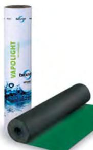
VAPOLIGHT è un telo sottotegola bituminoso consistente in un poliestere non tessuto impregnato con un compound elastomerico e rivestito su entrambe le facce con uno speciale tessuto polipropilenico. Applicazione: VAPOLIGHT è idoneo per essere posato a secco o mediante chiodatura. Impieghi Consigliati: VAPOLIGHT è un freno vapore e strato protettivo sottotegola per coperture a falda ventilate e non, realizzate su strutture in cemento o legno.
