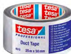
Descrizione del prodotto. Tesa® 4610 è un duct tape con caratteristiche basiche e un attrattivo profilo di performance. Il supporto in PE è rinforzato con un tessuto PET da 18 mesh e rivestito con un adesivo in gomma sintetica appiccicosa con un buon grado di adesività su vari substrati. tesa® 4610 è un nastro autoadesivo con proprietà per una vasta gamma di applicazioni. Caratteristiche:
