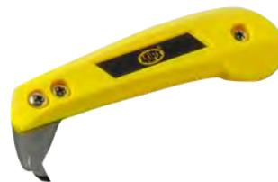
Impiego: design speciale per il taglio di lastre in gessofibra. Incidere due volte con forza le lastre in gessofibra con il cutter aiutandosi con una riga in metallo. Rompere la parte risultante dall'incisione appoggiandosi su un bordo di sostegno.
