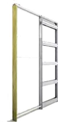
Controtelaio in Kit per porte a scomparsa per impiego con montanti da 75 mm in pareti in cartongesso di spessore totale 100 mm. E' composto di: 1) KIT per assemblaggio telaio tipo ad anta semplice con innesti ad incastro . 2) KIT per montaggio carrello di scorrimento. Per telai con anta doppia e' necessario prevedere il montaggio del KIT per anta doppia in abbinamento con il telaio tipo.
