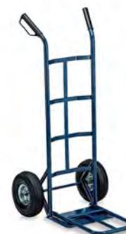
Struttura tubolare in acciaio. Portata massima 200kg . Vernice anti ruggine arancione. Maniglie rivestite in gomma con protezione dita. Ruote pneumatiche con valvola. Dimensioni. Massime. Larghezza 53cm- Profondità 44cm - Altezza 114cm - Ruote - Diametro 26cm - Spessore 7.5cm. Piano di trasporto. Larghezza 35cm- Profondità 20cm. Alette protezione gomme - Larghezza 10cm - Altezza 16cm
