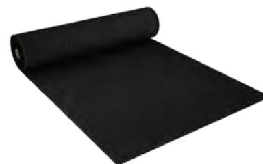
Schermo bituminoso sottotegola, utilizzabile anche come freno a vapore ( $S_d = 40\text{ m}$ ). Il prodotto consiste in un poliestere impregnato con un compound bituminoso rivestito su entrambe le facce con una speciale finitura in polipropilene. Dimensioni: 1 x 50 mt.
