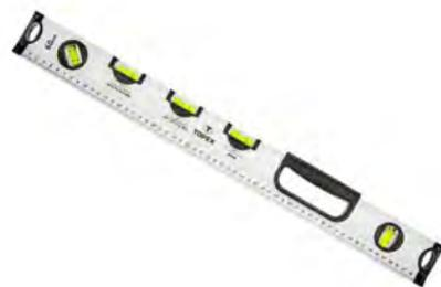
Il livello speciale TOPEX presenta 5 fiale inclinate a 0°, 1,5°, 3,5°, 45°, 90°. Maniglia comoda per misure più facili. La configurazione della fiala consente di definire le pendenze, ad es. per tubi.
