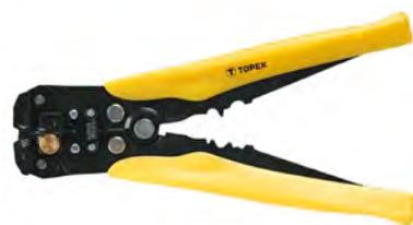
Spelafili automatico OPEX, lunghezza 210 mm, campo di lavoro da 0,5 mm<sup>2</sup> a 6 mm<sup>2</sup>. Permette la regolazione della portata e della pressione. Le impugnature ergonomiche si adattano perfettamente alla mano per un migliore comfort di lavoro. Dispone inoltre di ganasce per chiudere i terminali dei cavi.
