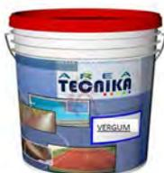
Guaina liquida elastomerica monocomponente. Prodotto a base di resine stirolo acriliche modificate e plastificate. Ha elevata elasticità, ottima adesione al supporto, elevata resistenza all'acqua, agli agenti atmosferici e al calpestio. È ideale per impermeabilizzare terrazzi, tetti, pareti, etc. Base Bianco - Grigio - Rosso - Verde Resa per mano 5 - 6 mq/l. Diluizione con acqua 10 - 40 % a volume. Essiccazione 5 - 6 ore. Applicazione pennello - rullo
