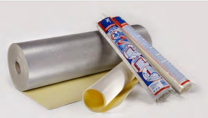
Pannello termoriflettente in resina di polietilene rigida accoppiato ad un film alluminizzato. Info: In resina di polietilene rigida accoppiato ad un film alluminizzato rifrangente con superficie gofrata. Dimensione: cm 70 x 100. Disponibile anche rotolo: cm 100 x 20 m.
