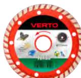
Il disco diamantato del segmento VERTO con un diametro esterno di 115 mm consente di tagliare in modo efficiente elementi in calcestruzzo, cemento armato, granito, marmo, pietra, mattoni, ecc.
