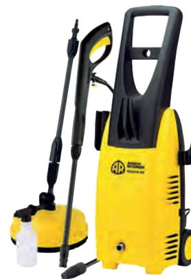
Pressione (bar/MPa) 160 • Portata (l/h) 480 • Temperatura di alimentazione (°C) Max. 50 • Potenza allacciata (kW) 2,1 • Peso (kg) 8,2 • Pompa: a 3 pistoni assiali in acciaio inox temperato.
