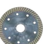
Disco diamantato di ottima qualità con "Turbo Design", ultrasottile (DHTS 115 = 1,7 mm; DHTS 125/DHTS 230 = 1,8 mm). Applicazioni: ideale per grès porcellanato e granito. Taglio pulito. L'elevata qualità di questa lama permette di tagliare la maggior parte dei materiali da costruzione.
