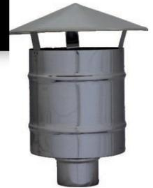
I cappelli per canna fumaria statici sono dispositivi che usano la forza dinamica del vento per aumentare il tiraggio della canna fumaria. La costruzione del cappello crea una differenza di pressione che forza il movimento dell'aria nel condotto. Deve essere montato su estremità terminali di canne fumarie per ventilazione
