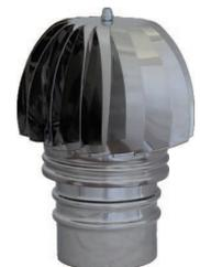
Il Terminale Eolico, è l'elemento finale di un Canale da Fumo a parete doppia. Grazie alla sua particolare geometria, per effetto della rotazione eolica, si crea all'interno del canale una depressione che facilita l'espulsione "forzata" dell'aria.
