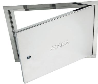
Sportelli per la custodia e la compartimentazione di contatori per l'ACQUA. Sono completi di zanche a murare, ricavate nella parte interna della cornice, e di chiave in plastica a quadrello per l'apertura e la chiusura. Sono disponibili in varie misure e vengono realizzati in lamiera zincata, acciaio inox e rame.
