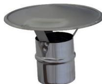
Il Terminale Cinese, è un elemento che si installa alla sommità di un Sistema Camino a parete doppia, secondo quanto previsto dalla Norma UNI EN 1856-1. Un cappello a falda larga, evita l'ingresso delle acque meteoriche garantendo il libero deflusso dei fumi, anche in caso di installazione in zone particolarmente ventilate; non tutela il sistema da eventuali nidificazioni primaverili, per opera di volatili.
