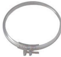
La Fascetta di Bloccaggio INOX, rappresenta l'elemento necessario per serrare ogni giunto interbicchiere e creare la continuità di un Sistema Camino. In abbinamento alla guarnizione silconica a triplo labbro, garantiscono la tenuta del sistema, secondo quanto previsto dalla normativa UNI EN 1856-1.
